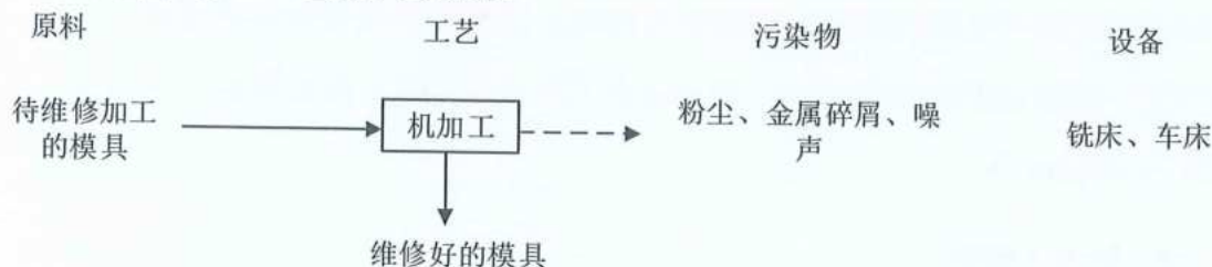
图 3-8 项目营运期生产工艺流程及产污环节图
