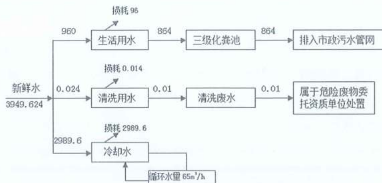
图 3.8 本项目水平衡图(单位: \text{m}^3/\text{a} )
