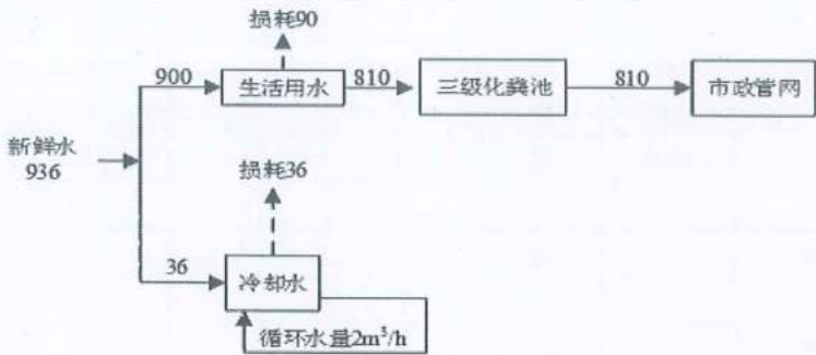
图 3.6 一期扩建后项目水平衡图(单位: t/a)
